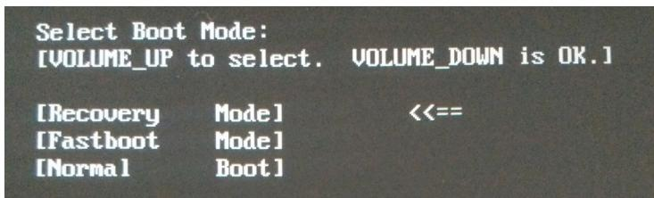
Vai a “Reboot” o “Normal Boot” oppure riavvia il dispositivo premendo il pulsante di reset sotto il pulsante del volume con un oggetto sottile.
