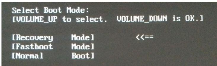
Naviguez vers « Reboot » ou « Normal Boot » ou redémarrez l'appareil en appuyant sur le bouton de réinitialisation situé sous le contrôle du volume avec un objet pointu.
