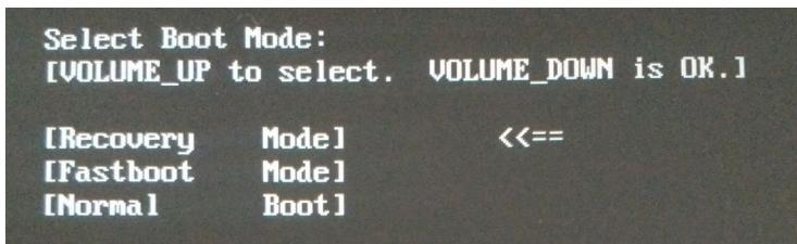
Navigieren Sie zu “Reboot” bzw. zu “Normal Boot” oder starten Sie das Gerät neu, indem Sie den Reset-Knopf unterhalb des Lautstärkereglers mit einem dünnen Gegenstand betätigen.
